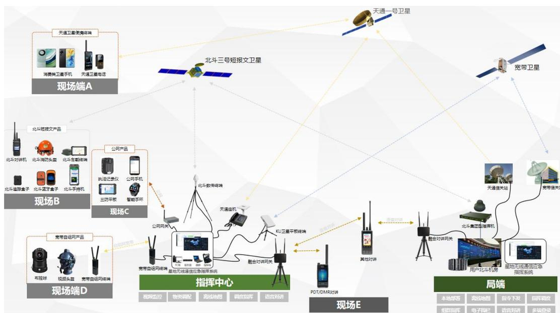
图 1：设备组成和通信流程图
